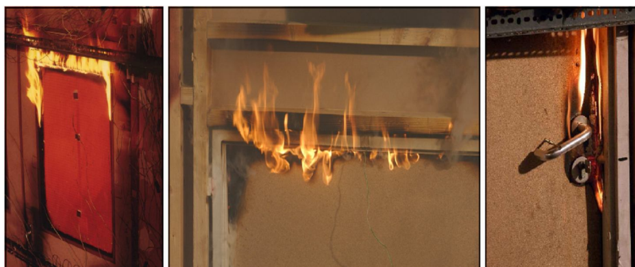
3. sz. kép: Lángáttörés a tűzvizsgálat során
