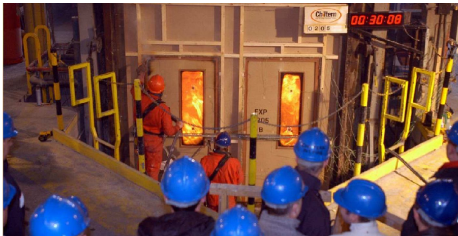
2. sz. kép: A tűzgátló ajtó vizsgálata
