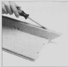
**2** Helyezzük be a sarokstabilizátorokat az előre megjelölt furatokba és hornyokba. A sarokstabilizátorok meghosszabbított kényeztetési helyek kívánalmanknak megtekintésén megmunkálhatók. A keretkőva tartományában lévő első stabilizátort alapvetően egyoldalon meg kell rögzíteni.
